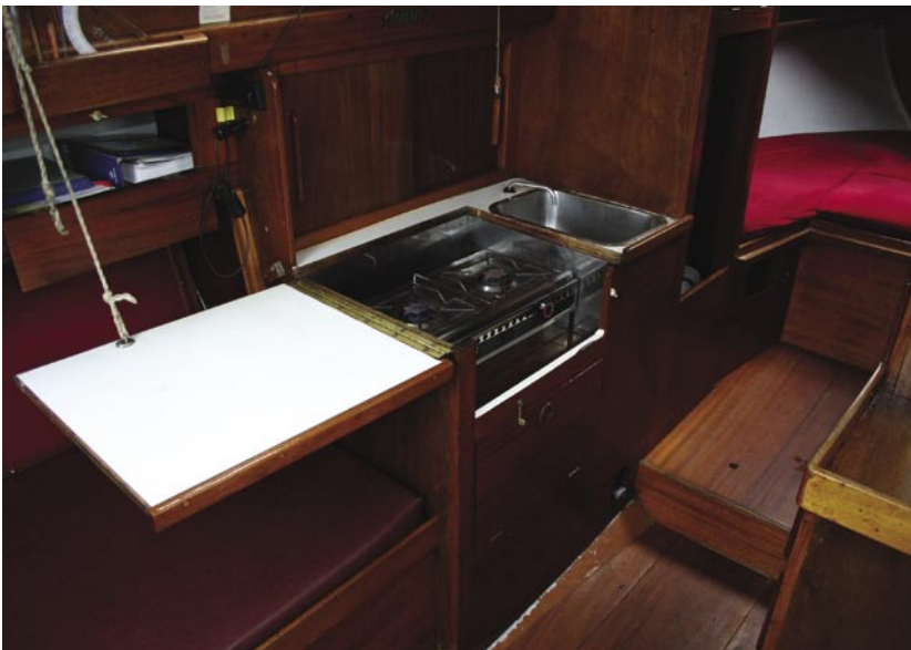
Die Pantry schließt sich an Backbord an den Salon an und ist längs eingebaut. Der Smutje hat hier auch im Seegang einen ruhigen Platz und findet ausreichend Halt
